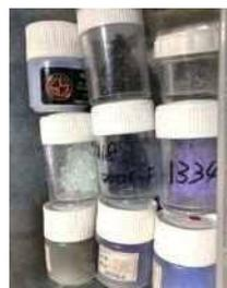
石材の色に合うガラス粒を調合し、ボンドで石に付着させ、最後は研磨仕上げ
